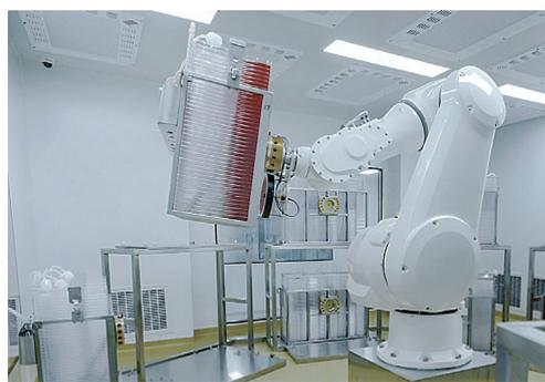
カメラとストーブリコネクタによるガイドを使ってセルフファクトリーをセットするロボット。各セルフファクトリーには 160 トレイのワクチンが含まれる
