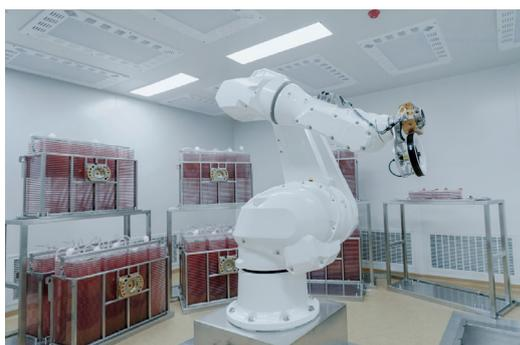
ステリクリーンロボットがセルフファクトリーの充填と溶液交換のプロセスをサポートする様子
